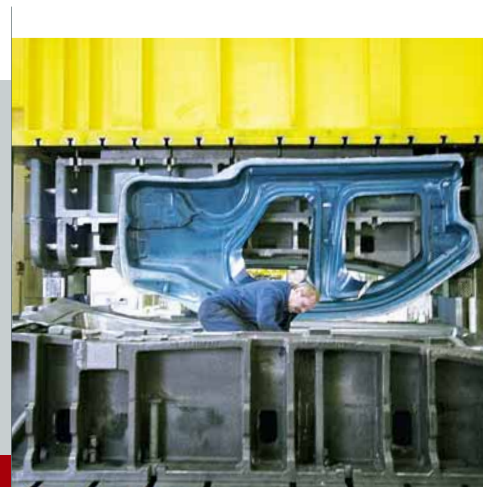
Maßarbeit: Test eines Presswerkzeuges für Karosserieteile bei KUKA Werkzeugbau im Erzgebirge
