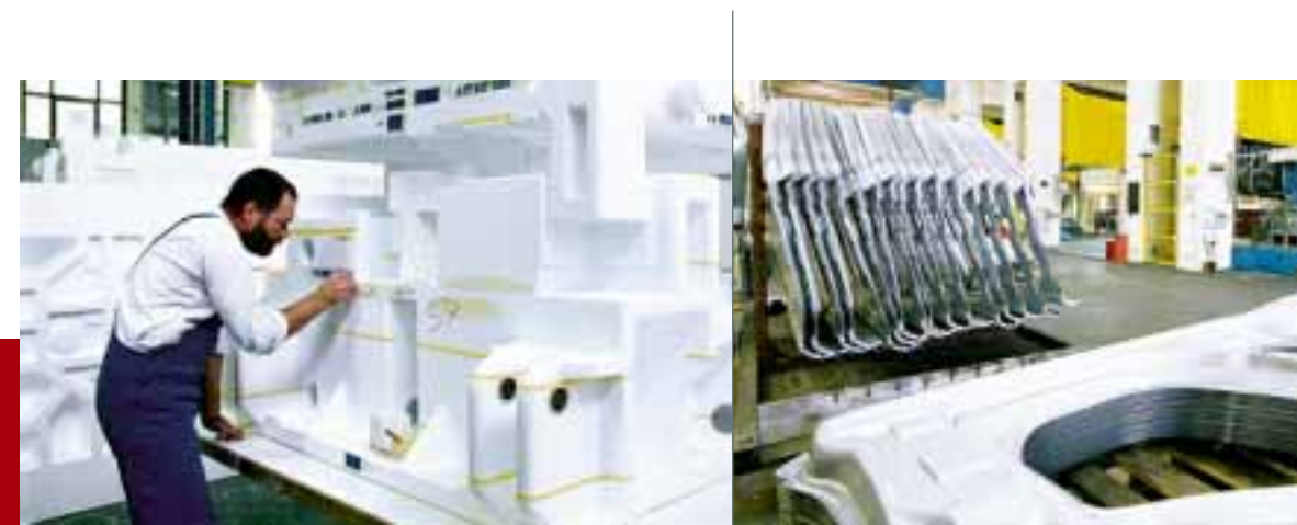
Vom Styropormodell zum fertigen Karosserieteil: Ein Mitarbeiter der KUKA Werkzeugbau Schwarzenberg verleiht der Gussvorlage für ein Presswerkzeug den letzten Feinschliff
