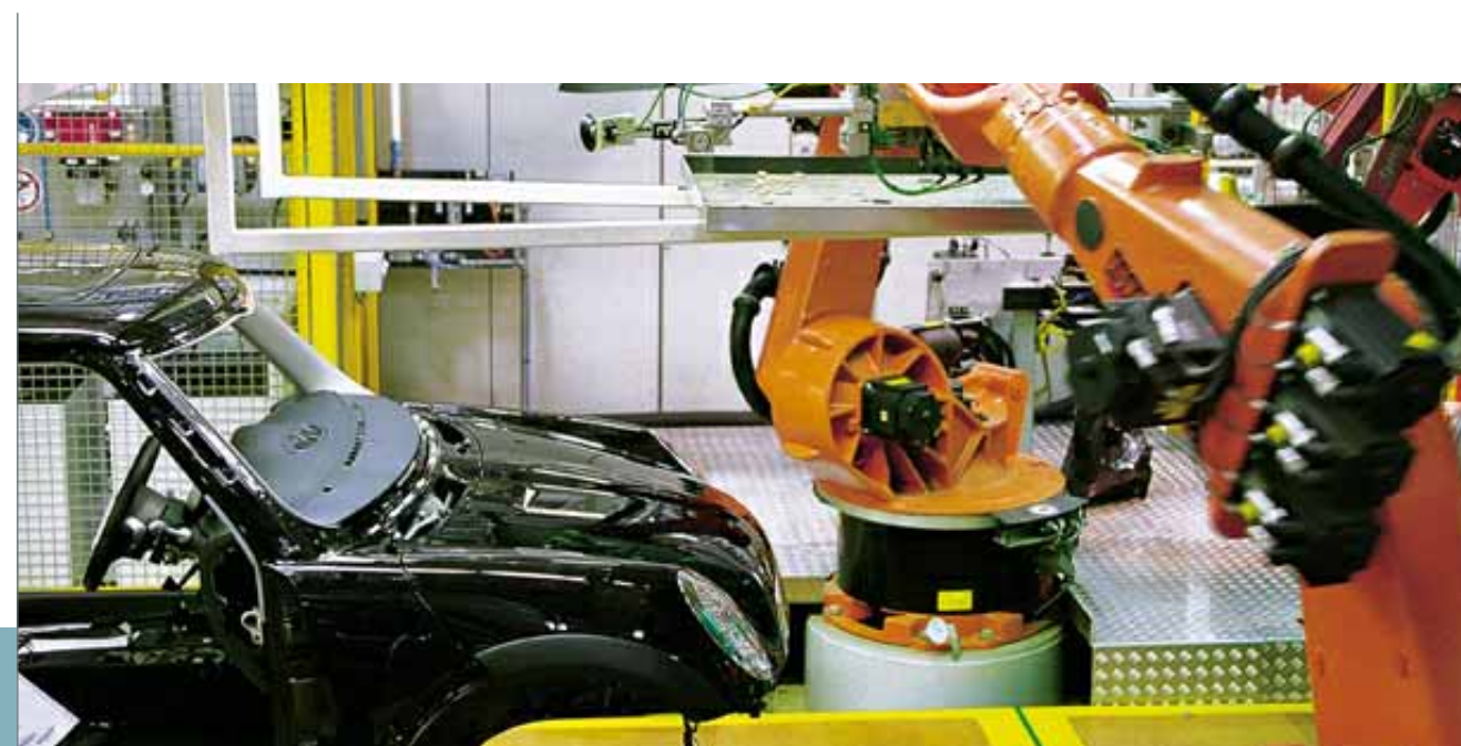
Durchblick: KUKA Roboter beim Einfügen der Fahrzeugscheiben des neuen BMW-Mini
